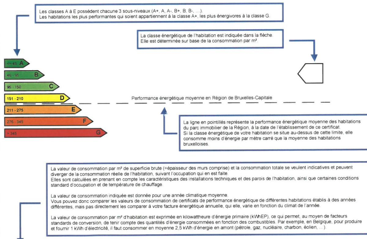
Consommation par m<sup>2</sup> [kWh EP/(m<sup>2</sup>.an)]
